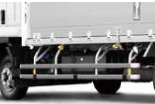
サイドバンパー (アルミ製) *GVW11t (アルミ製ステー)
