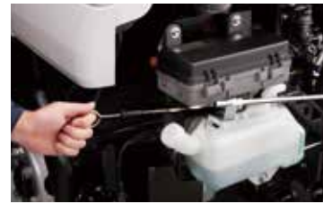
エンジンオイル点検口
