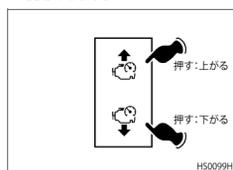
※ エンジン回転数を通常のアイドル状態(自動調整)に戻す場合は、アイドリングコントロールON/OFFスイッチの状態を“OFF”にしてください。
