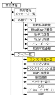
※ マルチディスプレイより、“車両情報”の“ゲージ一覧”から選択することにより、“エンジン冷却水温”を表示させることができます。詳細な設定方法は、車両に備え付けの取り扱い説明書をご確認ください。
