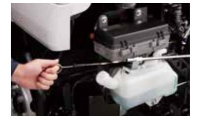
エンジンオイル点検口
