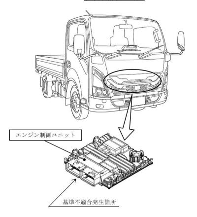
小型トラックにおいて、開発時のエンジン制御プログラムの評価が不適切なため、上流NOxセンサの故障診断が確定した際にEGR(排気ガス再循環装置)が作動を停止し、設計意図と不一致となる。そのため、保安基準第31条の細目告示第41条別添48の車載式故障診断装置(ディーゼル重量車J-OBDII)の技術基準を満足しない。
