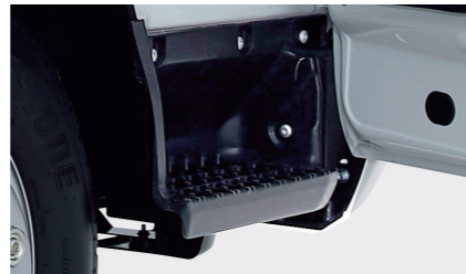
ステップの最適化(標準キャブ) ドア半開時の乗降性に配慮し、ステップの位置を後方化。ステップ形状も、ドア半開時でも足のせしやすい形状に変更しています。
