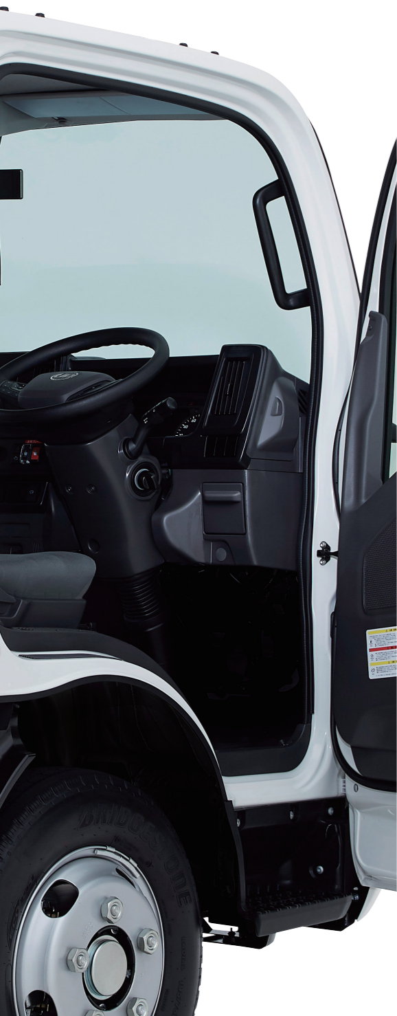
ドア開度の最適化(標準キャブ) 室内からドアを閉める際の操作性向上のため、ドア開度を最適化。
