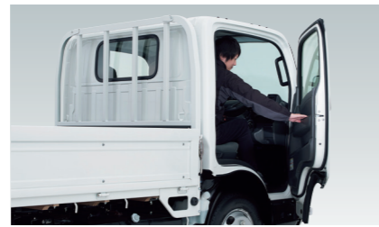
ドア開度の最適化(標準キャブ) 室内からドアを閉める際の操作性向上のため、ドア開度を最適化。
