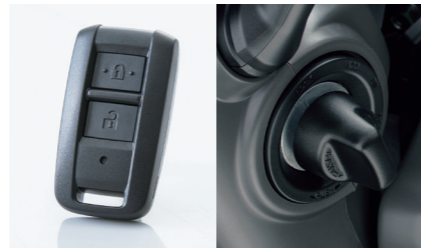
キーレスライド※ リモコンをポケット等に入れたままドアのボタンに触れるだけで、ドアの施錠・解錠が可能。エンジン始動もスイッチを回すだけで可能です。乗降の多い運行で効果を発揮します。
