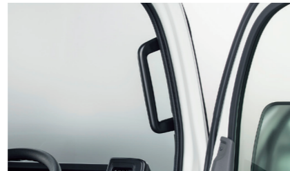
アシストグリップ 全キャブ通してグリップの長さを延長し、小柄な方から大柄な方まで、乗降性向上を図りました。
