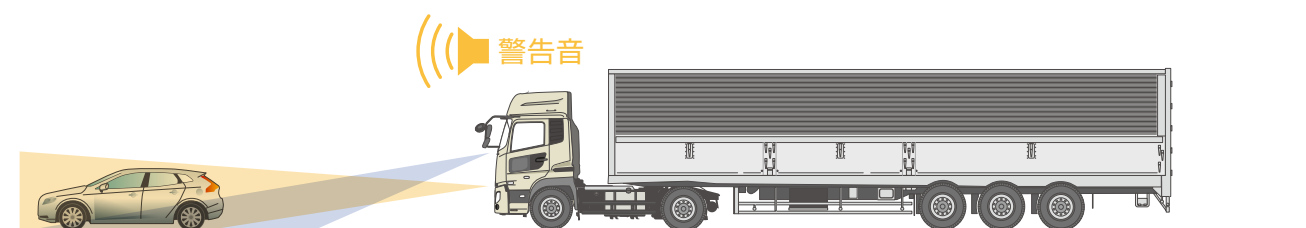
2.走行中に衝突の可能性のある車両を前方に検知すると、早期に警告灯とウォーニングメッセージの表示、警告音で注意を促します。
