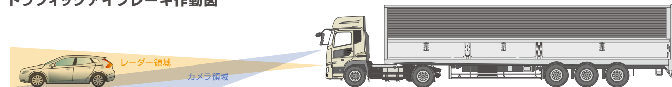
1.ミリ波レーダーとカメラの機能により、前方の状況を監視します。
