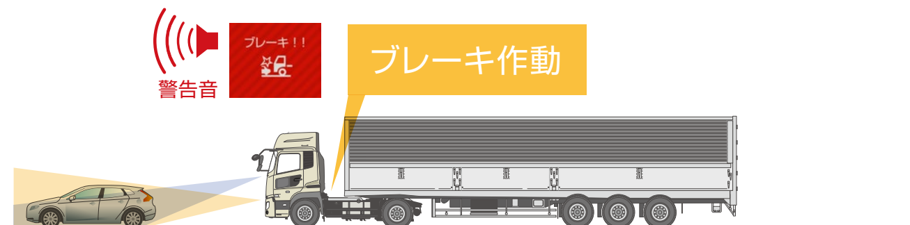
3.追突する可能性のある距離に車両が近づくと、警告灯とウォーニングメッセージの表示、警告音で注意を促し、同時に速やかにブレーキをかけて衝突の被害を軽減します。
